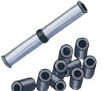
Hydroexpansive Dichtung zum hermetischen Abdichten von Abstandsrohren aus PVC, von Schalungstafeln und -formen. Wird mit der speziellen "Dreibackenzange" zentral bezogen auf die Abstandsstücke angebracht. Verbrauch: *1-2 Dichtungen /m<sup>2</sup> Verschalung*. Aussehen: *Runder Dichtungsring* - Farbe: *Schwarz* - Packung: *Schachteln mit variablem Inhalt.*
