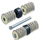
Zylindrischer Deckel aus Wellplastik mit eingebautem hydroexpansiver Muffe zum hermetischen Abschließen der Abstandsrohre für Metallschalungen. Lässt sich mit einem leichten Hammerschlag und anschließendem Festschrauben mit elektrischem Schrauber oder Handschraubendreher befestigen. Verbrauch: *1-2 Dichtungen/m<sup>2</sup> Verschalung*. Aussehen: *Kunststoffdeckel* - Farbe: *Schwarz* - Packung: *Schachteln mit variablem Inhalt.*
