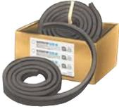
Hydroexpansive Dichtfuge, vorgeformt, für hermetisch dichte Aufkantung, Mauern und Fundamente, realisiert aus einer Soda-Bentonit-Mischung und speziellen Polymerzusatzstoffen, wird normalerweise vor Ort vor dem Betonguss positioniert und vernagelt. Potentielle Ausdehnung bis zu 5 Mal das Anfangsvolumen - Abmessungen: *mm. 25 x 20 in Rollen zu 5 mt* - Packungen: *Schachteln mit 6 Rollen (30 m)* - Aussehen: *Dichtband* - Farbe: *Schwarz*
