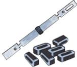
Hydroexpansive Dichtung zum hermetischen Abdichten der metallischen Abstandsbleche, von Schalungstafeln und -formen aus Holz. Wird mit der speziellen "Dreibackenzange" zentral bezogen auf die Abstandsstücke angebracht. Verbrauch: *6-8 Dichtungen/m<sup>2</sup> Verschalung*. Aussehen: *Rechteckiger Dichtungsring* - Farbe: *Schwarz* - Packung: *Schachteln mit variablem Inhalt.*
